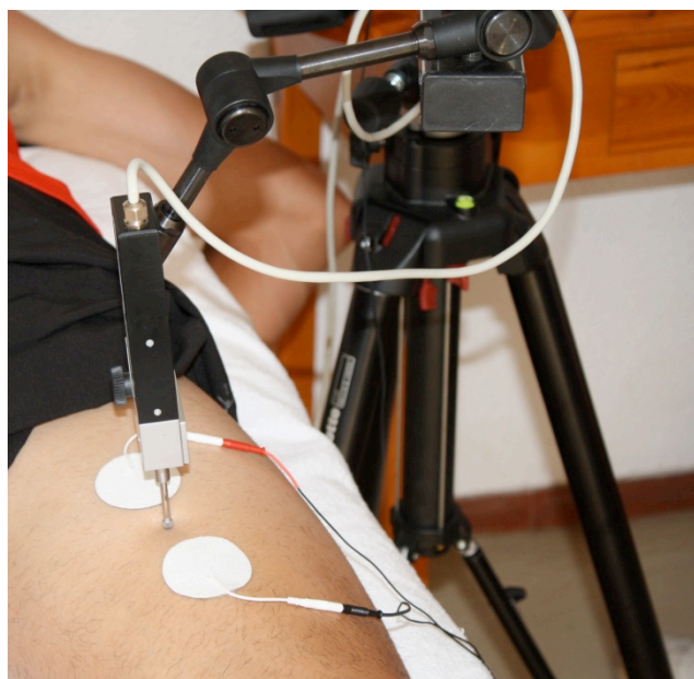
Figura 2: Colocación del los electrodos y el sensor de desplazamiento.
